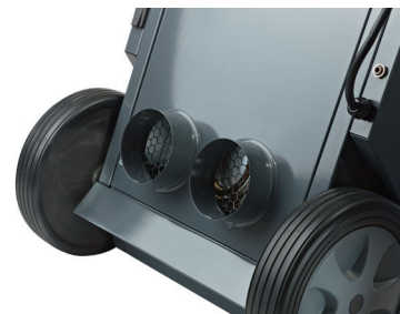
Modely 30 S a 40 S jsou vybavené 1kW topným tělesem (pro zvýšení topného výkonu) a vysokotlakým ventilátorem dovolujícím připevnění dvou flexibilních potrubí Ø100mm (max. 5m), pro cílený přívod odvlhčeného vzduchu
