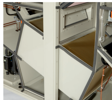
Vysoce účinné rekuperátory vyrobené z hliníku a ošetřené epoxidovým nátěrem jsou extrémně odolné vůči agresivnímu vlhkému vzduchu s obsahem chlóru.
