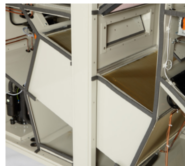
Vysokoučinné rekuperátory vyrobené z hliníku a ošetrené epoxidovým náterom, extrémne odolné voči agresívnemu vlhkému vzduchu s obsahom chlóru.
