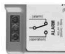
Pohonná jednotka ve stavu ALARM.
